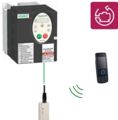
Configuración con software SoMove Mobile para teléfonos móviles a través de conexión inalámbrica Bluetooth®
