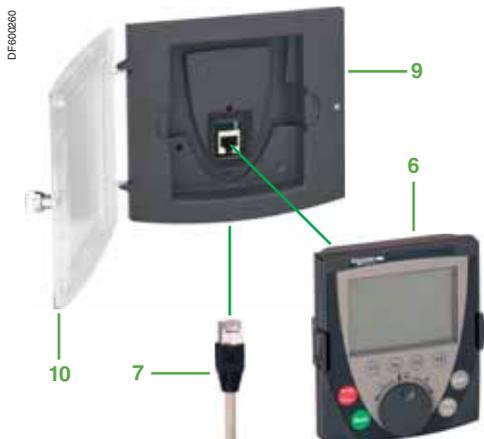
Ubicación remota del terminal de pantalla gráfica en una puerta de envoltorio: **6 + 7 + 9** con IP 54, **6 + 7 + 9 + 10** con IP 65
