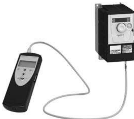
Configuración con la herramienta de configuración "Multi-Loader" conectada a ATV 312
